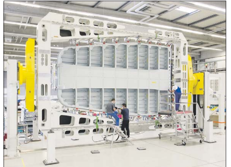
EADS Military Air Systems Augsburg entwickelte und fertigt die Cargo Door für den A400M in VAP®-Technik – das weltweit größte Flugzeugbauteil in dieser Technologie. Foto: EADS
