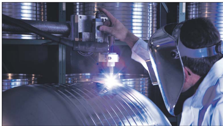
Schweißen eines Liners für die Abwassertanks des Airbus A330/340.
