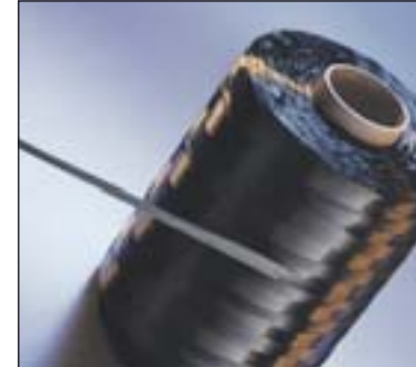
Carbonfasern lassen sich wie Nähgarn aufspulen.
